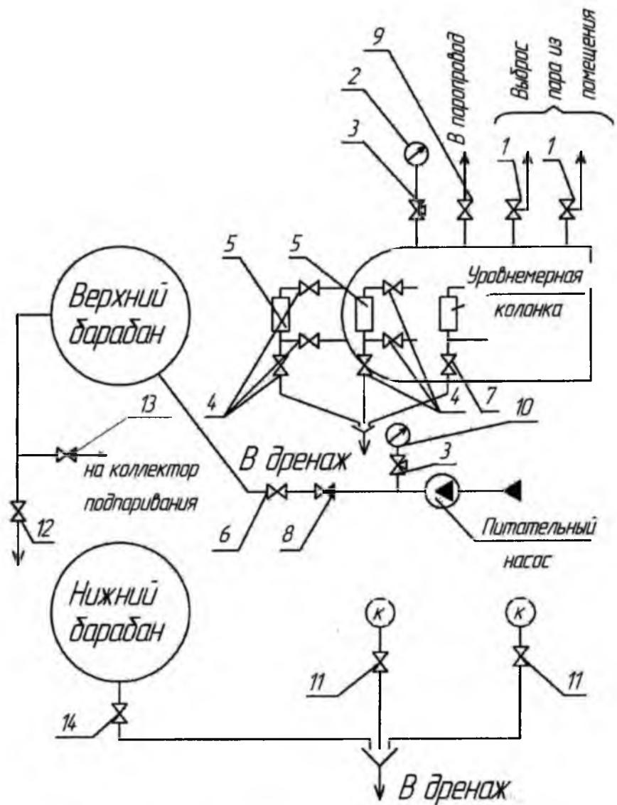
Рис. 4 Схема трубопроводов и размещения арматуры
